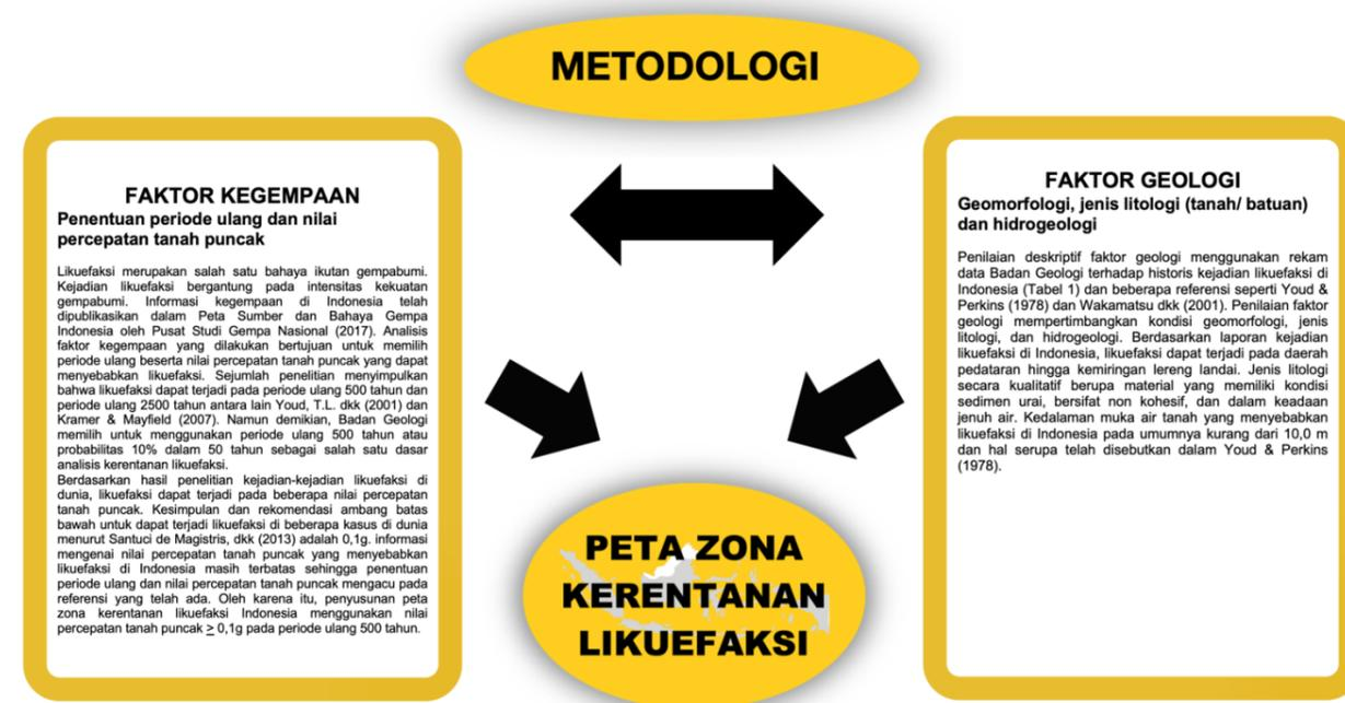
Gambar 3.12. Proses Penyusunan Indeks Bahaya Likuefaksi
